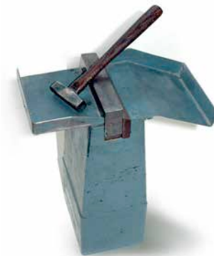
Werkzeug im Zeichen der Zeit: Handrichtgerät um 1900
